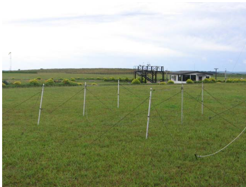
FIGURA 7.2 – Sistema Riômetro Convencional instalado no Observatório Espacial do Sul - OES/CRS/CIE/INPE – MCT.
