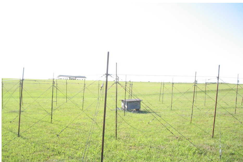
Figura 4.4: Fotografia das antenas do riômetro imageador no Observatório Espacial do Sul, São Martinho da Serra, RS.
